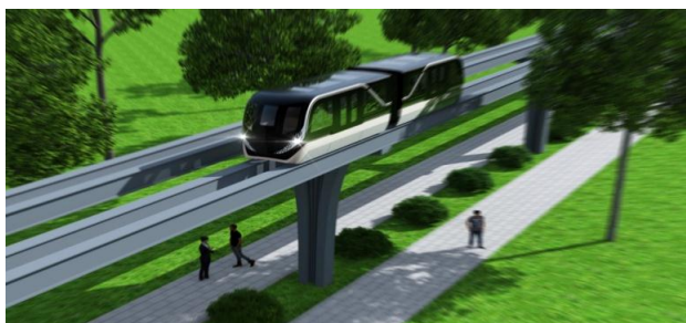
图 2.1.5-2 胶轮有轨电车系统（云巴）高架走廊形式
