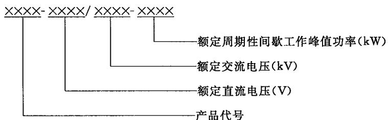
图 1 逆变装置型号
