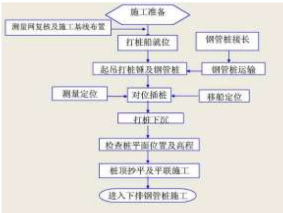
图 8.4-4 栈桥结构形式及施工工艺流程
