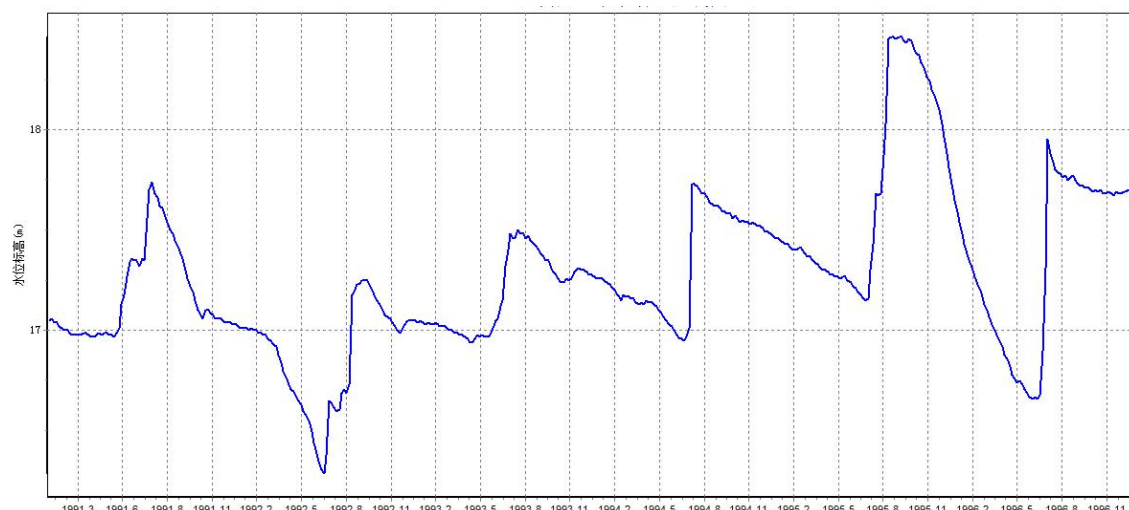
图 7.2-1 基岩裂隙地下水动态监测曲线图
