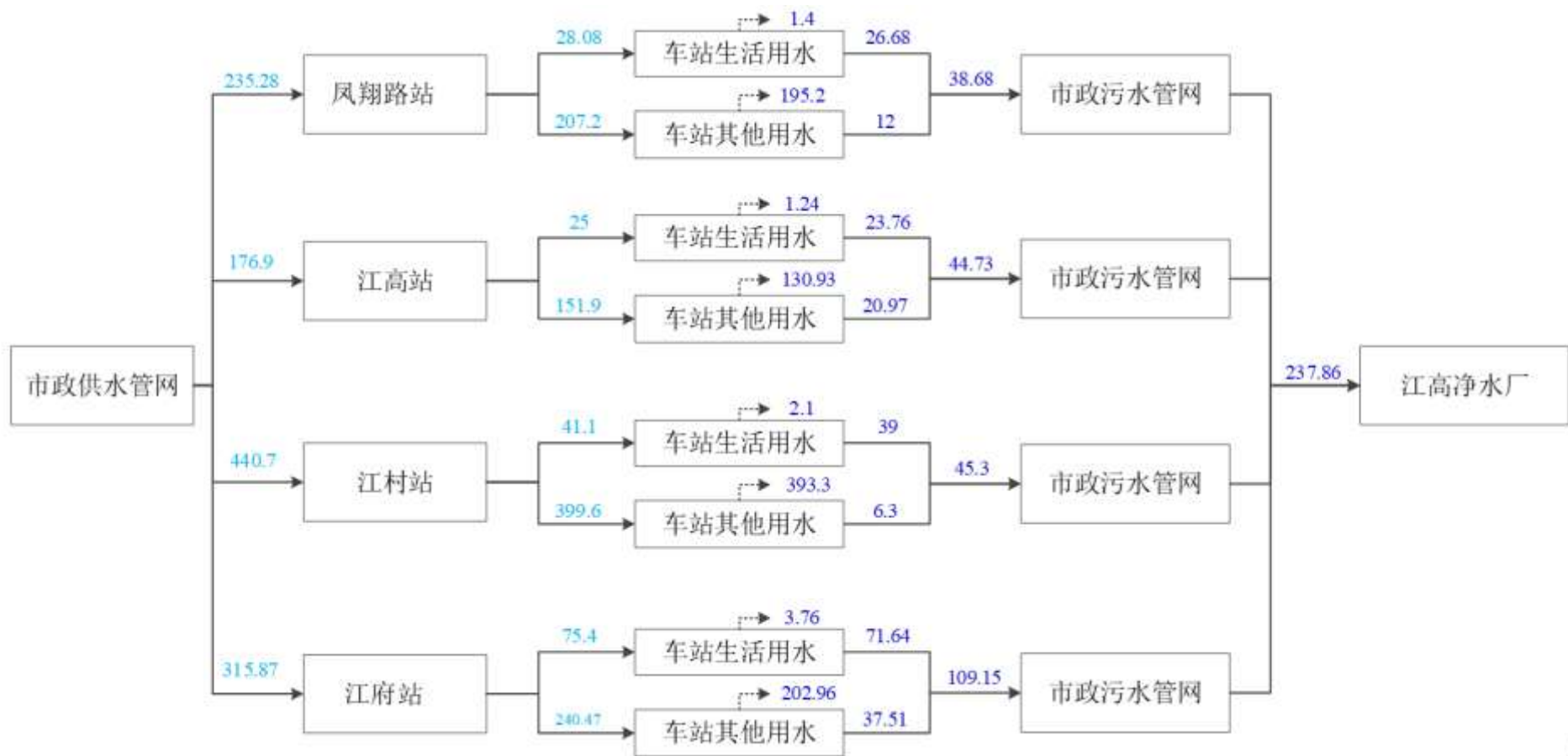
图2.2-1 本工程水平衡图 (单位: m³/d)
