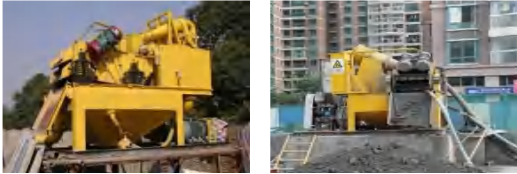
图 2.1-24 泥浆分离机渣土与水
