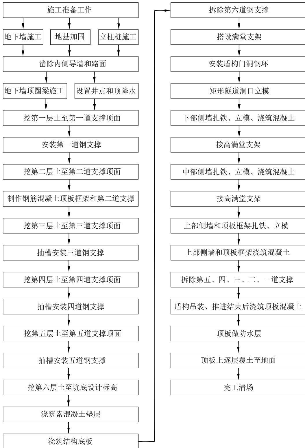
图 2.1-26 工作井施工流程图
